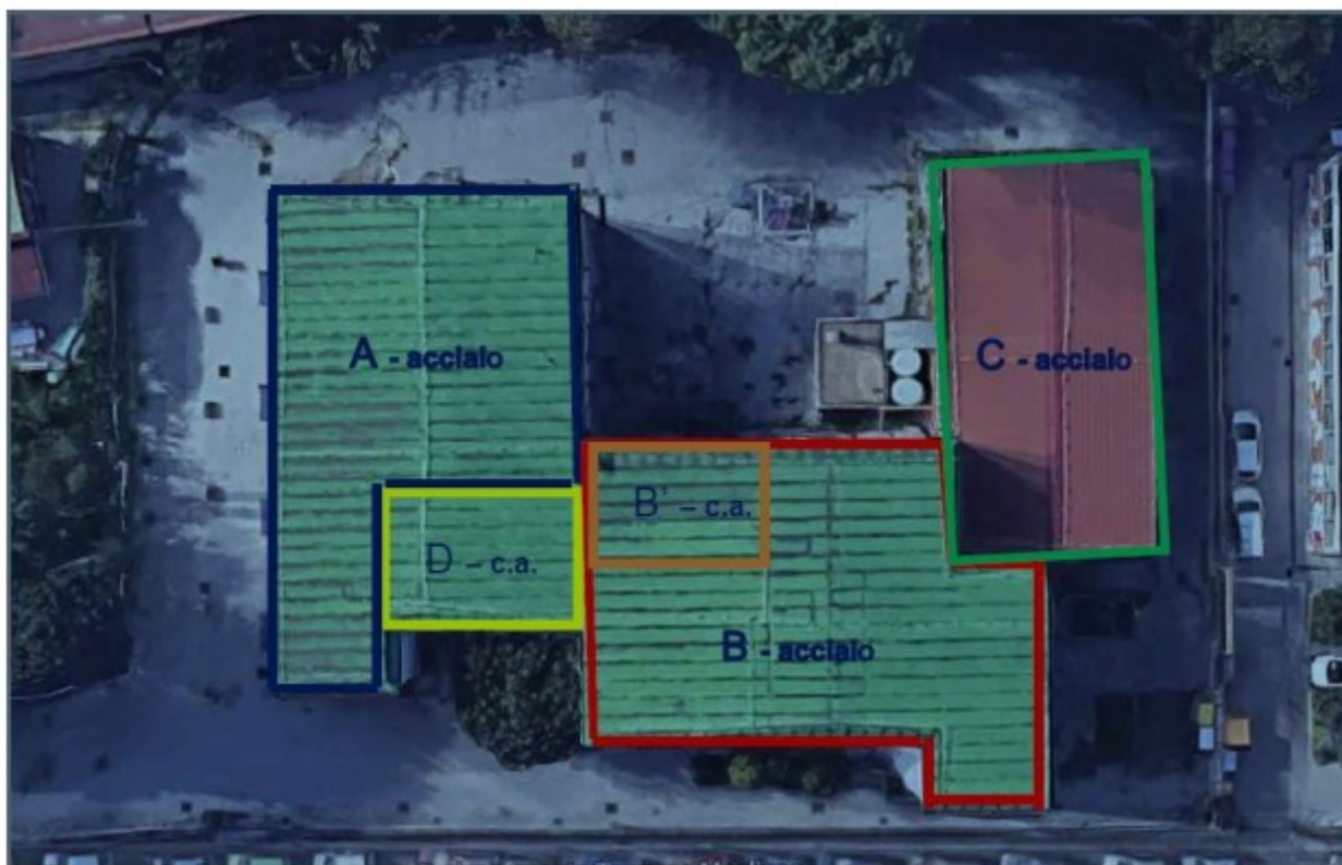
Figura 6 – schema planimetrico con individuazione dei corpi strutturali
