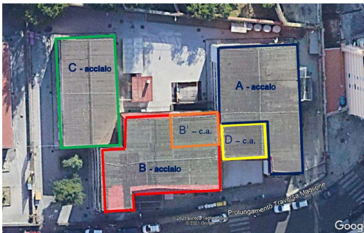
Figura 4 – schema planimetrico con individuazione dei corpi strutturali
